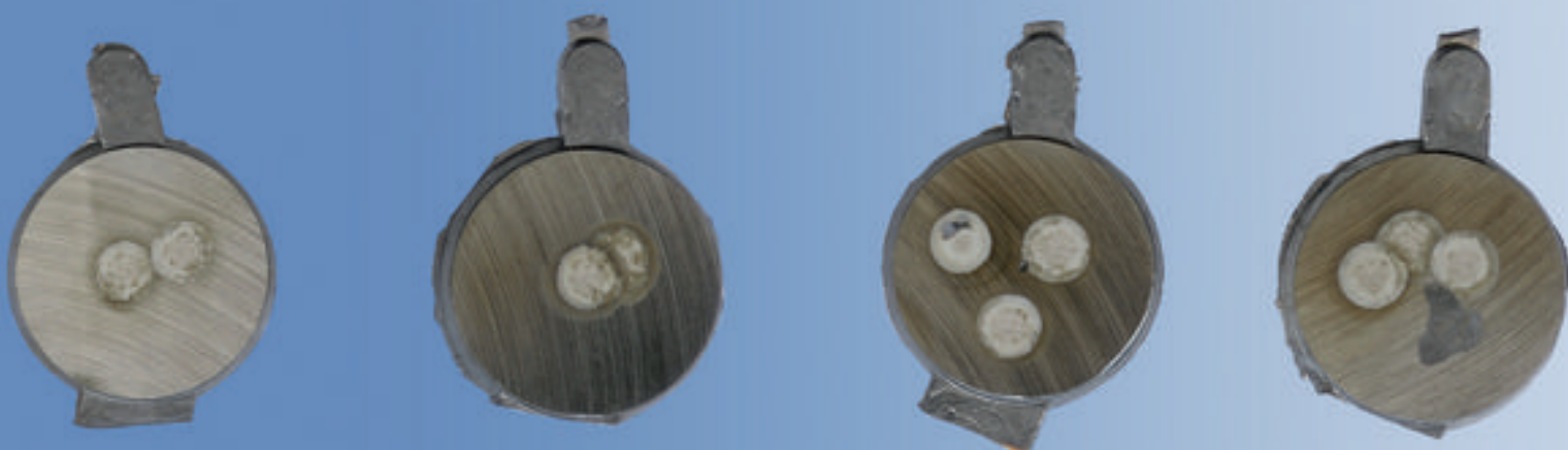
Espectrometría de erosión con chispa: manchas en muestras metálicas
