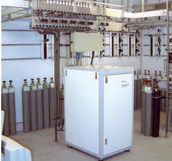
Espectrómetro de masa para el análisis de pureza de los gases
